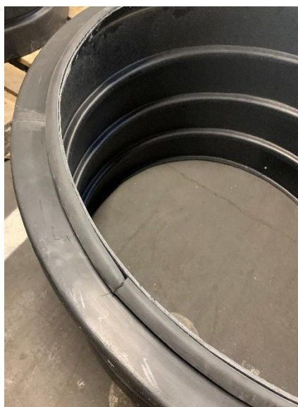
Figur 1: Fäst gummilisten mot kanten.
